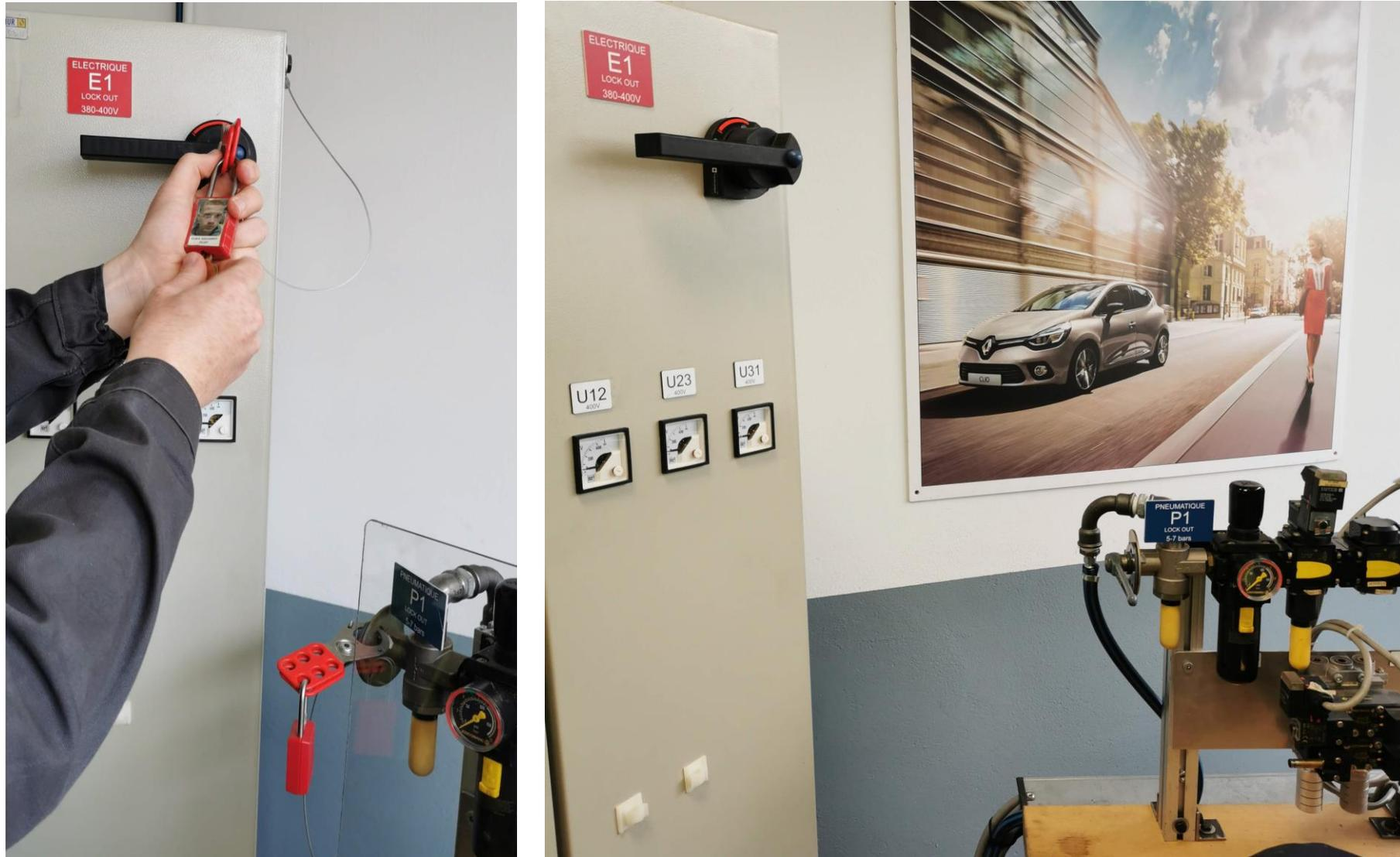
**Objectif :** Faire réaliser un LOTO par le stagiaire pour qu'il puisse manipuler le morillon / multilock + cadenas identifié ou carte d'identification afin de comprendre la logique associée. Identification et prise en compte de différentes énergies sur une « vraie » machine.
