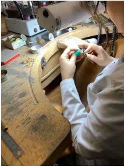
Figure 24: prise en pince du bijou à travailler sur la cheville.
