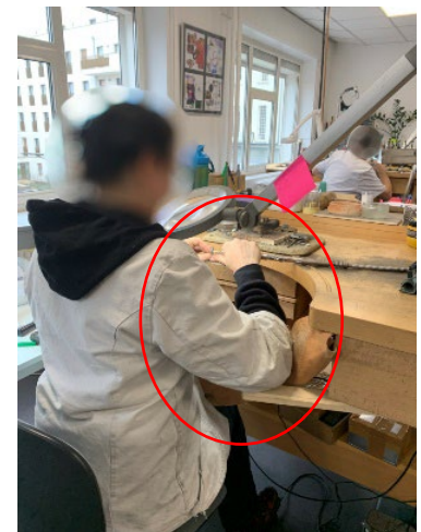
Figure 27 : Exemple de dispositif mis en place par une salariée pour compenser le poids du bras et éviter de poser le bras sur le plan de travail.
