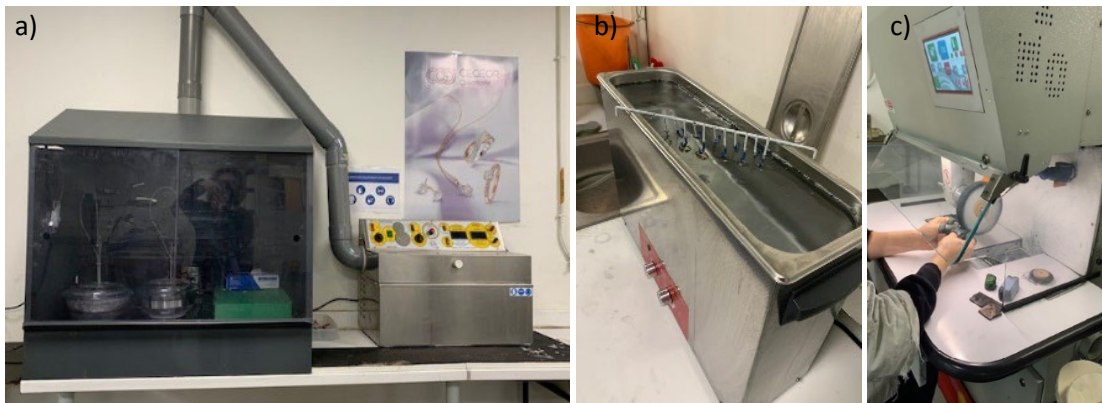
Figure 19: (a) Machine à électrolyse, (b) Machine avec bain de rinçage, (c) Poste de polissage.
