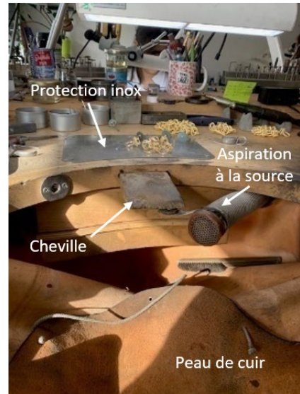
Figure 15: Exemple de poste de travail de bijoutier dans l'entreprise C
