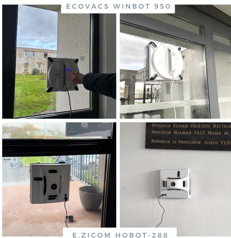
Robots lave vitre, nettoyage des surfaces vitrées intérieures et extérieures difficilement accessibles, Site universitaire IUT d'Amiens Novembre 2023
